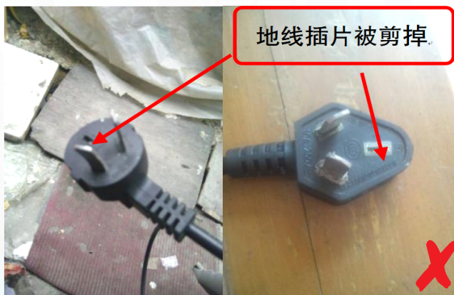
三孔插头地线插片被剪掉，可能发生触电事故
