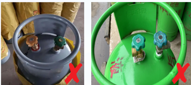
违规使用50kg的“气液两相”气瓶
